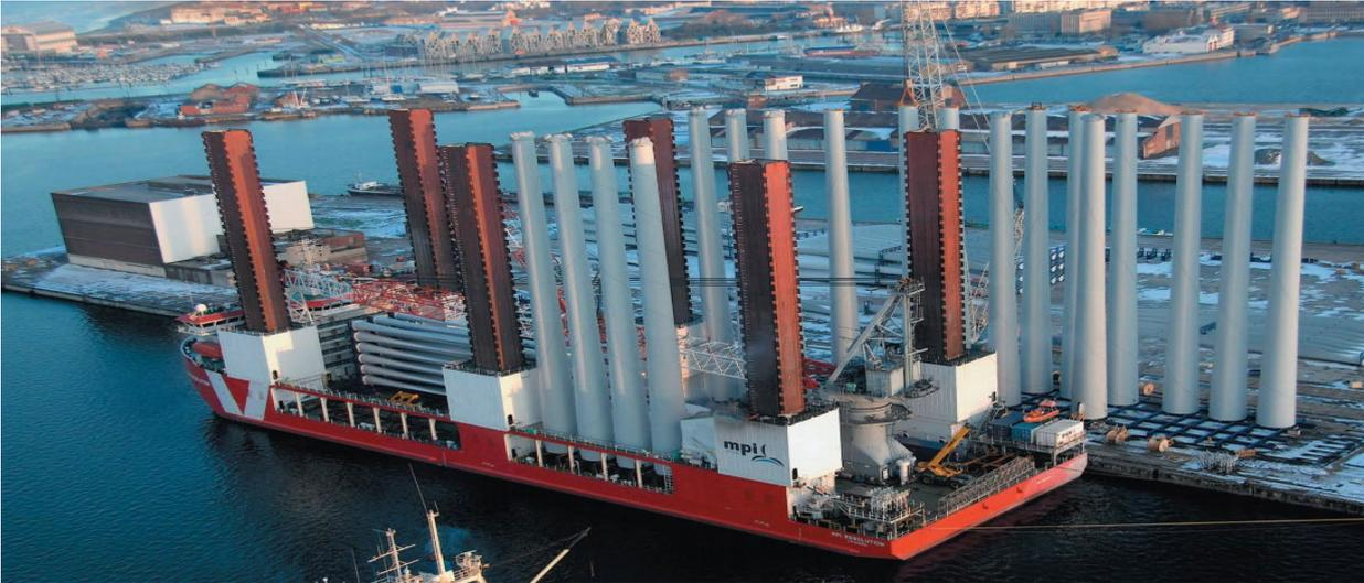
Ilustración 23 Buque para montaje de parques eólicos marinos, MPI Offshore.
