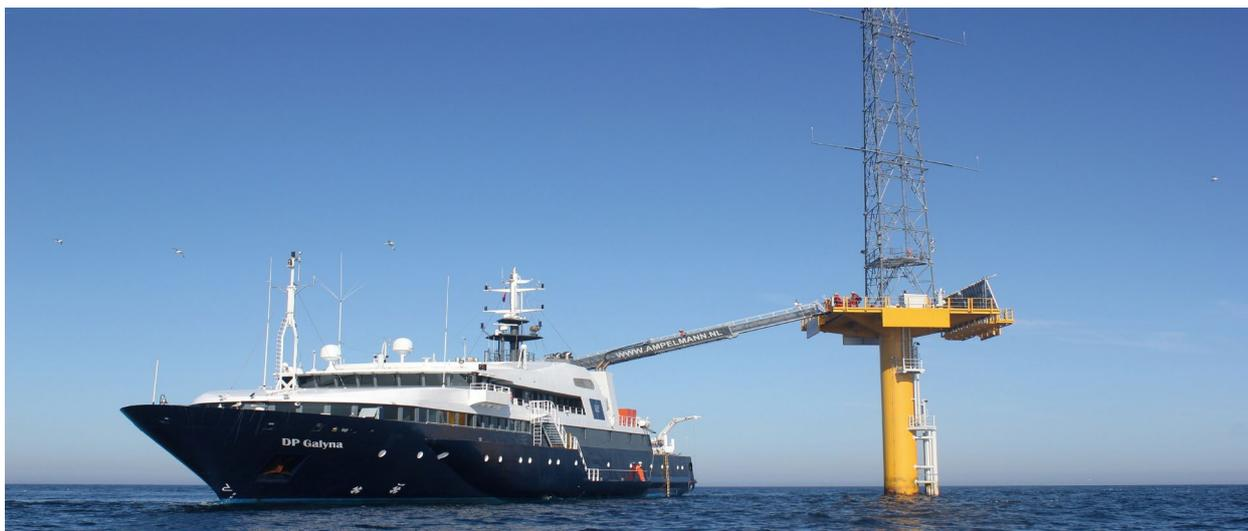
Ilustración 11 Floatels con sistema Ampelmann.
