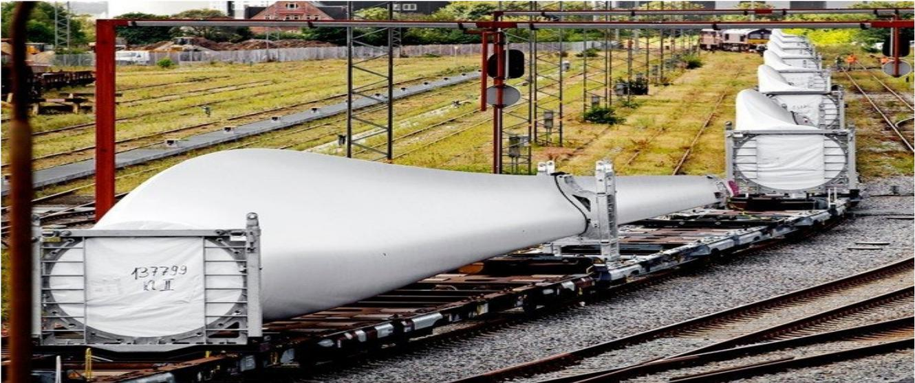
Ilustración 18 Implementación de sistemas para el transporte de palas de ferrocarril.
