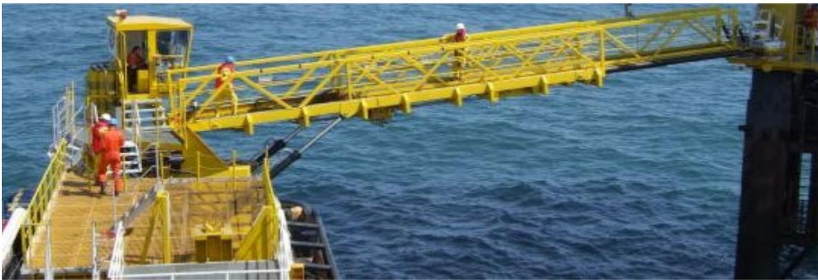
Ilustración 31 Acceso mediante sistema Ampelmann
