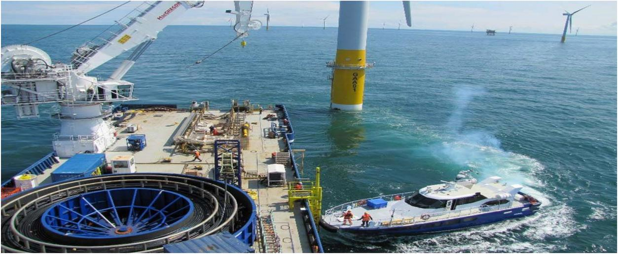
Ilustración 15 Barco de instalación de clave submarino.
