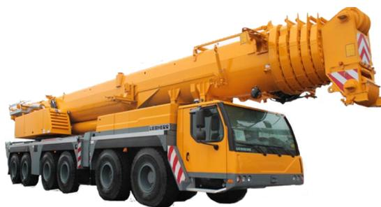
Ilustración 20 Modelo grúa telescópica
