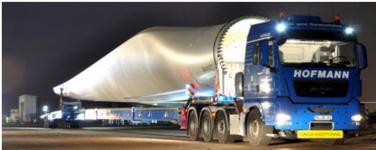
Ilustración 17 Camión Tele PX Wing Carrier.
