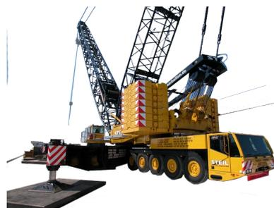
Ilustración 22 Modelo grúa de celosía sobre neumáticos
