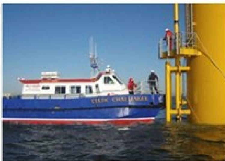
Ilustración 40 Transferencia del personal de barco al aerogenerador.
