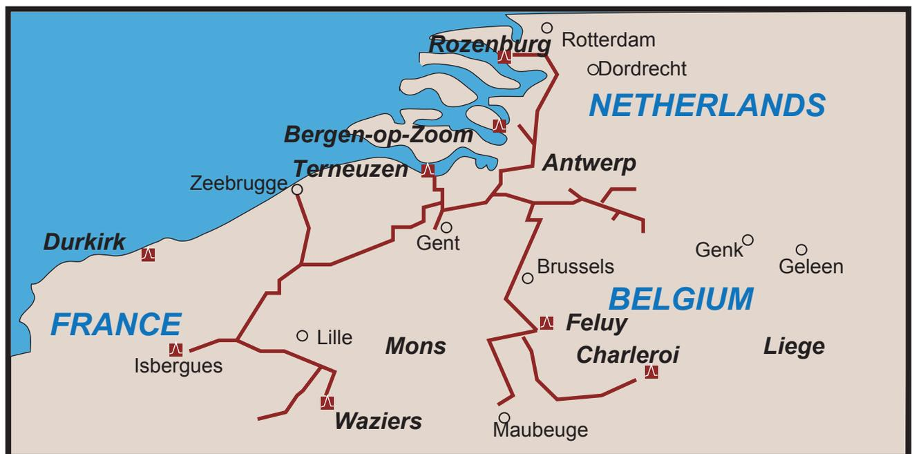
Ilustración 25: Gaseoducto Francia-Bélgica (Air Liquide Company.) Fuente: Air Liquide
