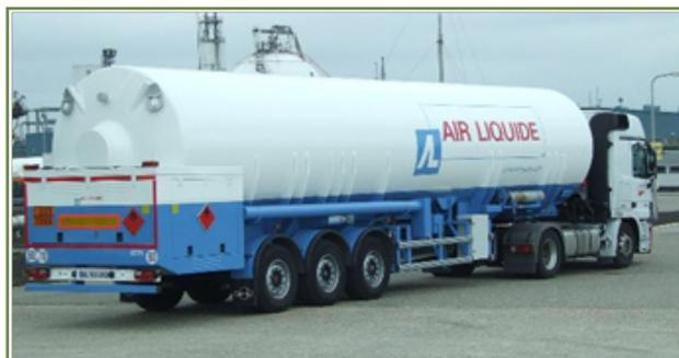
Ilustración 28: Camión cisterna para el transporte de hidrógeno líquido. Fuente: Air Liquide
