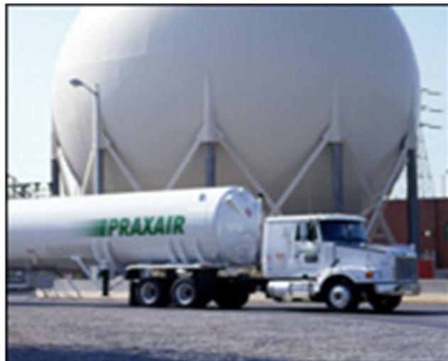
Ilustración 43: Camión de líquidos criogénicos para el transporte del hidrógeno. Fuente: Praxair
