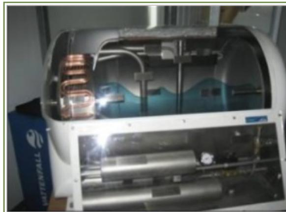
Ilustración 20: Tanque criogénico de H<sub>2</sub> líquido. Fuente: VattenFall
