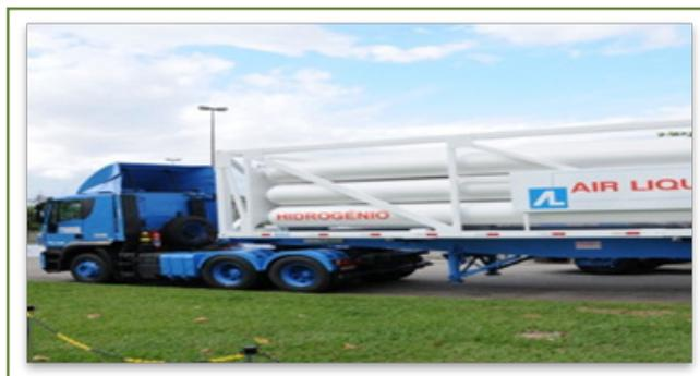
Ilustración 27: Camión de tubos para el transporte de hidrógeno gas. Fuente: Air Liquide
