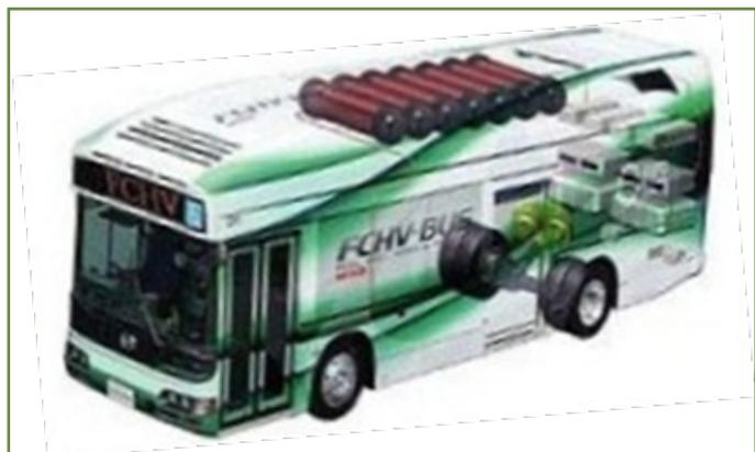
Ilustración 16: Disposición de tanques de hidrógeno a presión en un autobús. Fuente: Sin determinar
