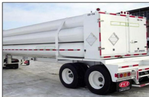
Ilustración 44: Remolques-tubo para el transporte del hidrógeno. Fuente: Sin determinar
